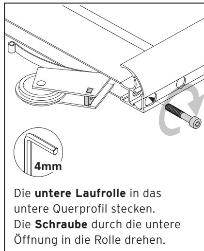
11_ Montage der Rolle
